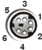
Рисунок Б-4. Номера контактов разъема клавиатуры
