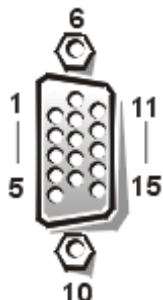
Рисунок Б-6. Номера контактов разъема видео
