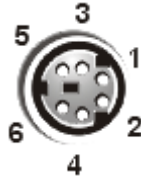
Рисунок Б-5. Номера контактов разъема мыши
